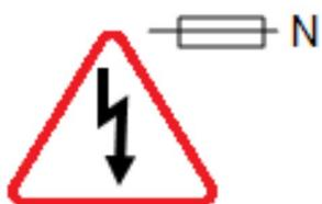
Осторожно – В некоторых случаях может быть предусмотрен предохранитель на нулевом проводе.
